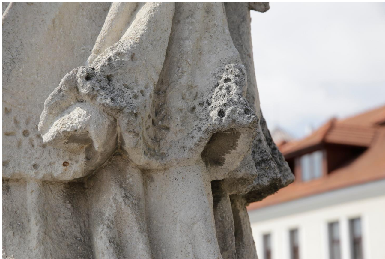
Obrázek 24 socha sv. Jana, detail: krusty a degradace povrchu
