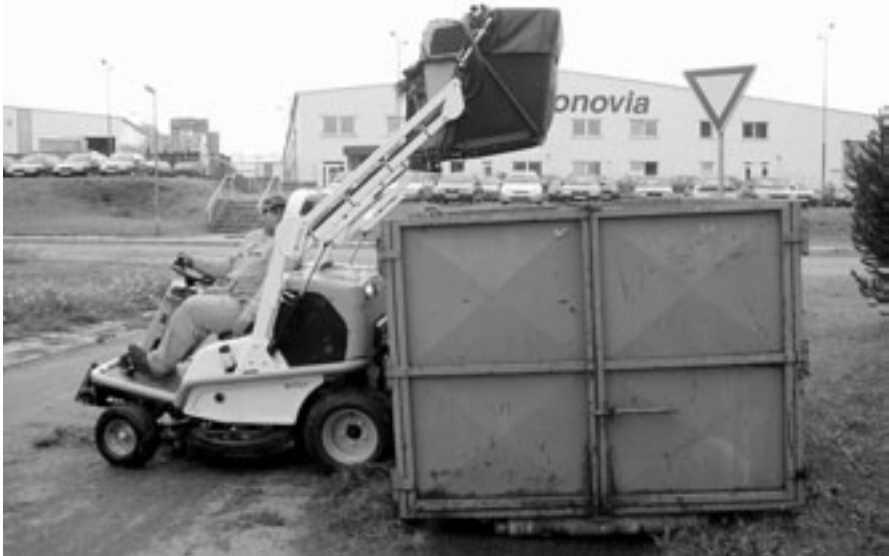
Pohled na nový traktor v činnosti pod vedením zkušeného pracovníka TS, pana Punčocháře. Velkou devizou nového stroje je hydraulické vysypávání koše do kontejneru, objem koše je účtyhodný 1 m 3 . FOTO: MGR. MIROSLAV BĀŇA
